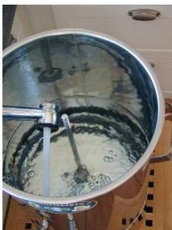
23l/ 53l Brauwasser einfüllen – bis ca. 2cm unter der oberen Markierung an der Zugstange bzw. am Füllstandsmesser. Folgen Sie den Anweisungen der Brausteuerung, indem Sie mit ENTER quittieren, daß Wasser eingefüllt ist. Die Pumpe entlüftet selbstständig und die programmierte Einmischtemperatur wird angefahren.
