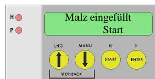
Wenn Sie das Malz eingefüllt haben quittieren Sie das mit ENTER. Zur Sicherheit erfolgt nochmals die Abfrage „Malz eingefüllt?“. Mit START starten Sie nun den eigentlichen Brauprozess mit dem Braumeister. Die Pumpe und Heizung schaltet ein. Die Würze steigt im Rohr auf und läuft über. Der Kreislauf ist entstanden und das Malz wird durch das Umpumpen über die nächsten Phasen ausgewaschen.
