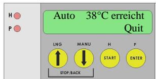
Mit Erreichen der Einmischtemperatur ertönt ein Signalton, welcher mit ENTER quittiert werden muß. Die Pumpe wird dadurch abgeschaltet.
