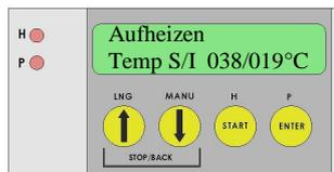
Pumpe und Heizung sind bis zum Erreichen der programmierten Einmischtemperatur eingeschaltet. Auf dem Display wird die Soll- und Ist-Temperatur angezeigt.
