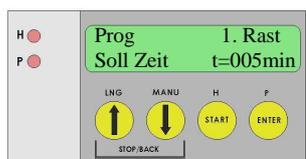
Mittels der PFEILTASTEN wählen Sie Zeit und Temperatur, welche Sie jeweils mit ENTER bestätigen. So programmieren Sie das Einmaischen, die Phasen 1-5 und das Hopfenkochen. Die Rast 5 steht auf 0 und wird nur bei speziellen Rezepten verwendet.
