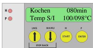
Wie in vorherigem Abschnitt beschrieben, wurde die Automatik fortgesetzt und das Hopfenkochen gestartet. Das Display zeigt wieder Zeit und Temperatur der Phase an. Da die Solltemperatur von 100°C nicht immer erreicht werden kann, beginnt die Zeit mit einer Karenzzeit von 3 min nach Erreichen von mindestens 95°C zu laufen. Wird bei der
