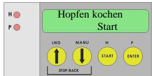
Nach Entfernen des Malzrohres quittieren Sie dies wieder mit ENTER. Zum starten des Hopfenkochens drücken Sie START. Pumpe und Heizung schalten sich wieder ein und die Automatik wird fortgesetzt.
