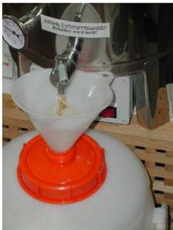
Würze mittels Trichter (siehe Bild) oder Schlauch in ein steriles 30l Kunststofffass abfüllen. Fass und Abfüllhilfen zuvor mit schwefliger Säure desinfizieren. Am Kesselboden befindliche Ausscheidungen nicht mit abfüllen.
