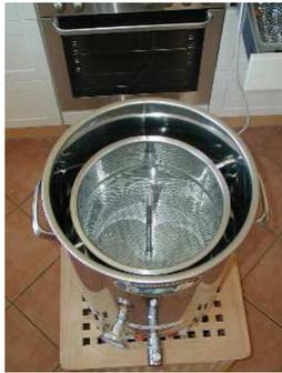
Mit Erreichen der Einmaischtemperatur ertönt ein Signalton, welchen Sie mit ENTER quittieren. Nun das Malzrohr einsetzen (mit aufgezogener Dichtung nach unten). Darauf achten, dass Dichtung mit Malzrohr zentriert und absolut eben auf dem Kesselboden aufsitzt. Siebblech bis auf unteren Rand einschieben (Rohr nach oben). Darauf Feinsieb einlegen (im Wasser unten auflegen).
